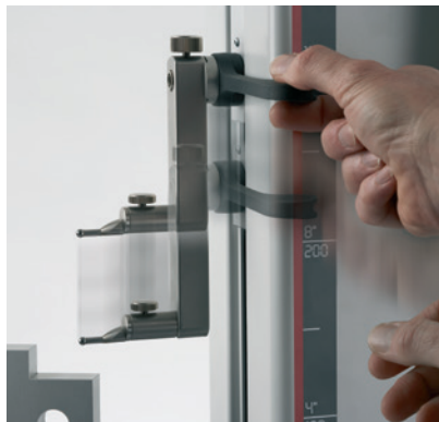
Bild 1. Messschlitten mit Hand in Richtung Messobjekt bewegen.
